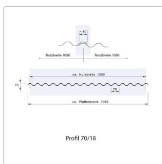
Transparente Lichtplatte aus PVC Ondex HR Profil Typ 70/18. Durch die biaxiale Reckung sind diese Lichtplatten extrem flexibel und dadurch praktisch unzerst
