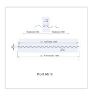
Transparente Lichtplatte aus PVC Ondex HR Profil Typ 70/18. Durch die biaxiale Reckung sind diese Lichtplatten extrem flexibel und dadurch praktisch unzerst
