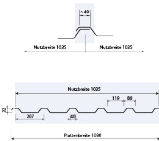
Transparente Lichtplatte aus PVC Ondex HR Profil Typ 35/207. Durch die biaxiale Reckung sind diese Lichtplatten extrem flexibel und dadurch praktisch unzerstörbar. Der koextrudierte UV - Schutz schützt vor schädlicher UV Strahlung. Die Hagelsicherheit wird für Hagelkorngrößen bis 4,0 cm
