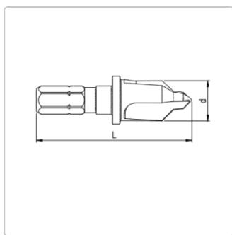
Stufenbohrer 10 mm mit integriertem Tiefenanschlag
