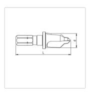
Stufenbohrer 10 mm mit integriertem Tiefenanschlag
